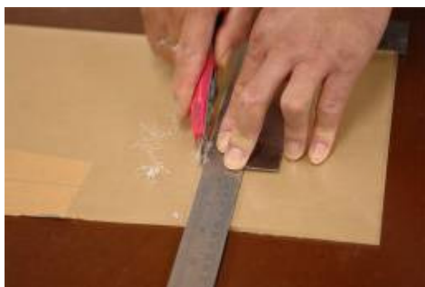
沿鋼尺等垂直邊緣拖拉亞加力膠切割刀
